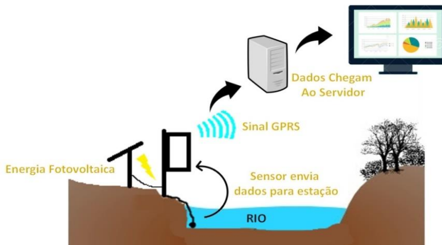
Figura 3 - Funcionamento de um sistema de monitoramento.
